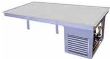
Stille Kühlung durch Kontaktberührung bei den Kühlplatten. Eignet sich zur kurzzeitigen Kühlung der Produkte. Eine längerfristige, dauerhafte Kühlung ist hiermit nicht möglich. Die Kühlplatten sind für GN-Bleche 1/1 geeignet. Alle Sichtseiten sind komplett in CNS 1.4301 geschliffen. Die Auslagefläche hat einen leichten Einhängewulstrand wegen anfallendem Tauwasser.
